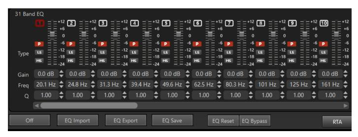
このエリアは、EQ 調整のメインパラメーターセクションです。調整可能な EQ パラメーターは全部で 31 段階あります。インターフェースボタン、プッシュボタン、矢印などを使用してパラメータを変更し、独自の要件を満たすパラメータ構成を調整できます。各セクションでは、PEQ タイプ、「Gain」、「Freq」、および「Q」のパラメータを設定できます。
